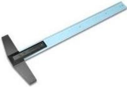
El brazo transversal es más corto. Se fabrican de madera o plástico. Se emplea para trazar líneas paralelas horizontales en forma rápida y precisa. También sirve como punto de apoyo a las escuadras y para alinear el formato y proceder a su fijación.
